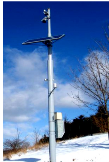
積雪観測システム 冬期の降雪量の観測
