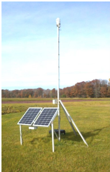
複合気象観測システム 各気象成分を観測
