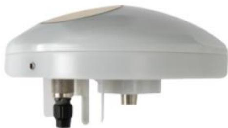
複合気象センサーSE-WSC11 はデジタル出力による ID 管理が行えます。GPS 受信機を搭載しており位置と時間、太陽位置の連続受信を行います。φ130×70mm超軽量 220gの手のひらサイズでコンパクトな本体には 9 要素が一体となっており高機能複合気象センサーです。設置が簡単に行えます。農業気象から防災気象など幅広くご使用いただけます。
