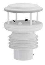
複合気象計 SE-CSUS4920-S はコンパクトでヒーター内蔵型のオールインワンウェザステーションセンサです。農業気象、防災気象、各種モニタリングシステム用のセンサとしてご使用いただけます。計測項目は超音波風向風速、ドップラー雨量計、照度計、気圧計、温湿度センサを内蔵しています。またデータの出力インターフェースはデジタル RS485/422、プロトコルは MODBUS RTU、アナログ電圧 0~10V が標準仕様となっています。他にネットワークロガー等に接続しリアルタイムデータを取得することが可能です。
